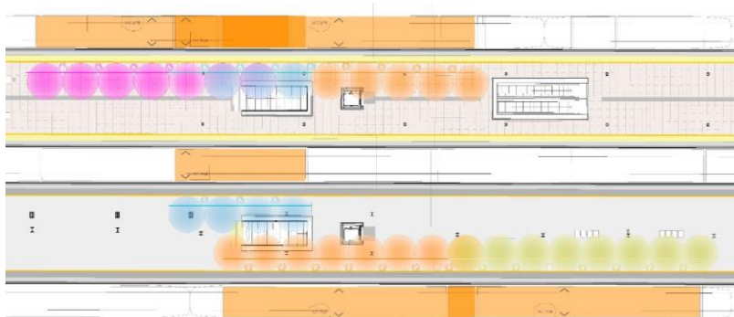
Figura 48. Esquema de distribución y disposición de dispositivos para señalética dinámica inteligente en andenes con diferente tipología de material rodante (fuente Ineco)
